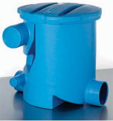
Filtro para água de chuva, para instalação dentro ou enterrado antes da cisterna. Graças a seu sistema duplo de limpeza (peneira grossa, depois fina) ele possui um grande eficácia, independente da vazão. Em função da forte inclinação do miolo filtrante a sujeira separada é continuamente encaminhada para a galeria pluvial.
