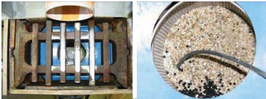
Abbildung 38: Links: Rückstände von MILLISIL nach den Versuchen mit feinkörnigen AFS; nach Entfernen des Plexiglas-Aufsatzes. Rechts: Im Grob- und Feinrückhaltefilter zurückgehaltenes Material nach den stofflichen Untersuchungen bzgl. grobkörniger AFS.
