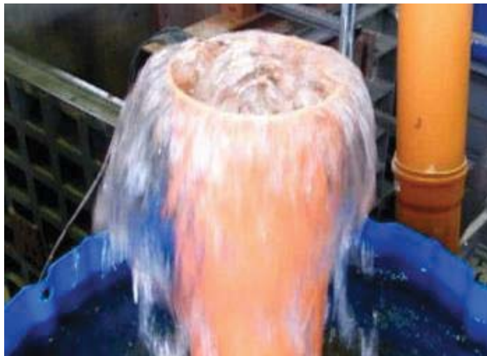
Abbildung 30: Austritt von Wasser aus dem Überlaufrohr bei einer Beschickungsmenge größer als 13,5 l/s.
