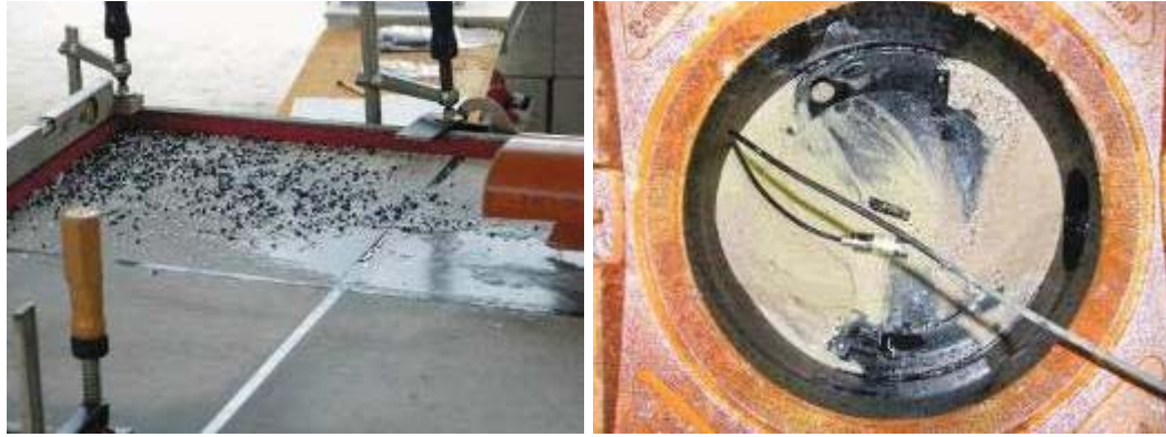
Abbildung 34: Links: Rückstand auf dem obersten Sieb nach Teilprüfung 1. Rechts: Blick von oben in die obere Kammer des Centrifoel® nach der Teilprüfung 1 (Kies-Sand/Schwebstoffe).
