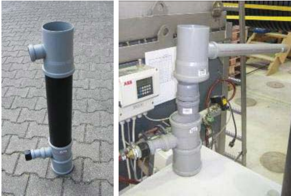
Abbildung 42: Links: Säule zur Ermittlung des Rückhalts von Schwermetallen (3P Hydrosystem).
