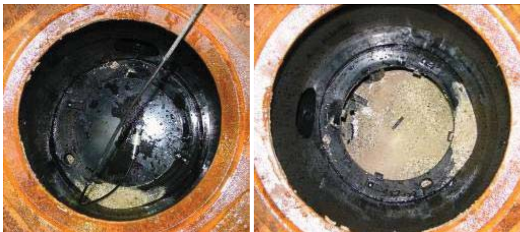
Abbildung 35: Blick von oben in den Centrifoel® nach dem Ausspülversuch. Links: obere Kammer; Rechts: mittlere Kammer.
